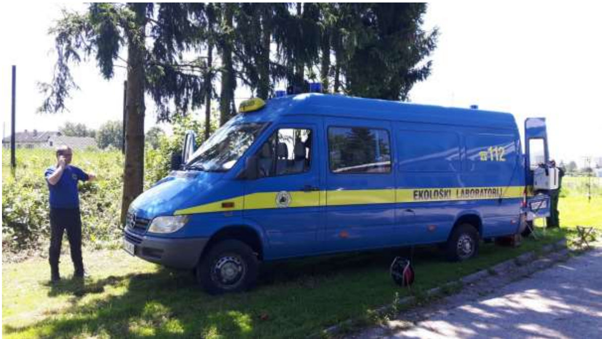
Slika 3: ELME (Ekološki laboratorij z mobilno enoto) ima na zadnja vrata vozila pritrjeno Reuter Stokes merilno celico na kateri je radijska postaja z APRS vmesnikom
