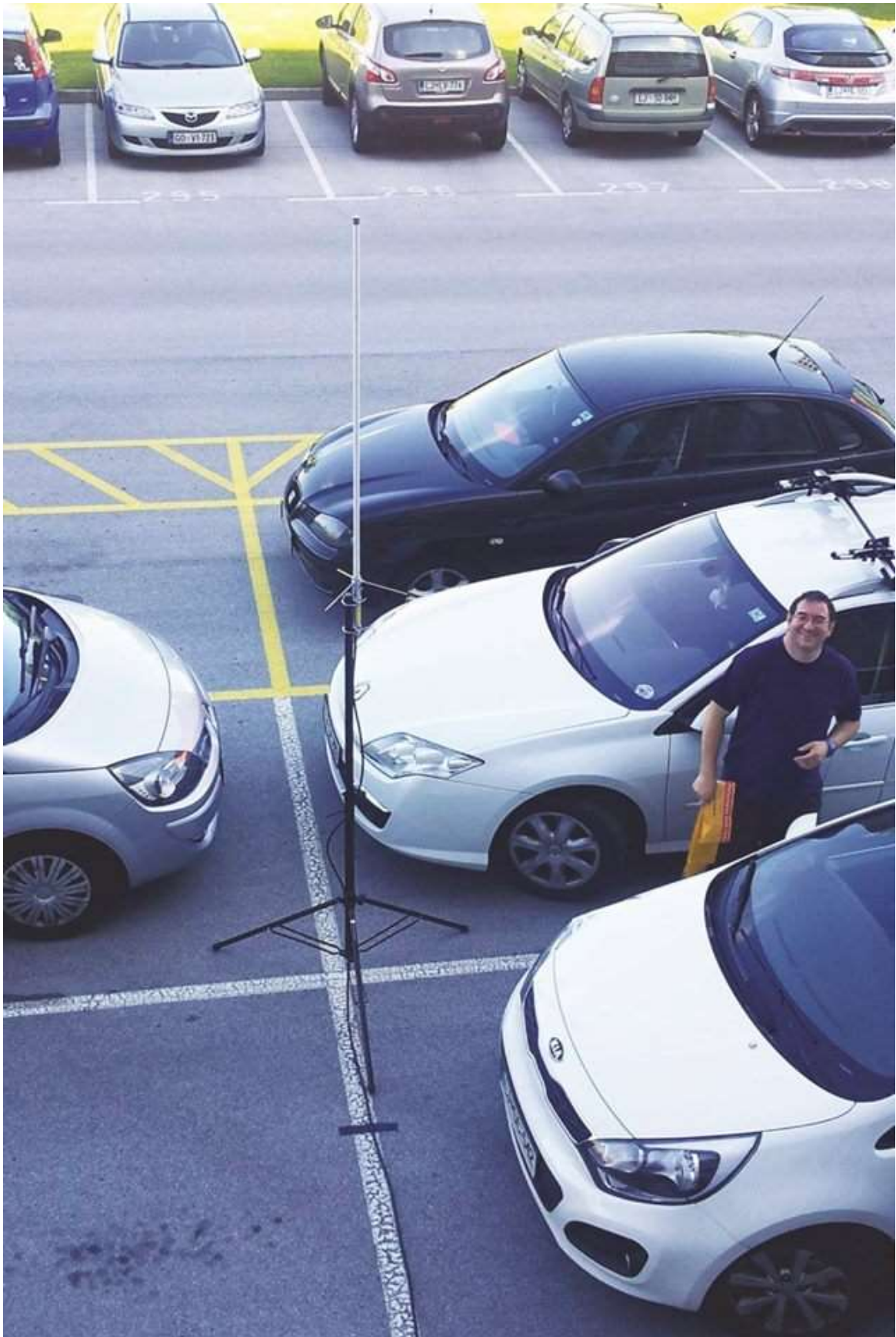
Slika 11: Improvizirano postavljena antena Diamond X-50N
